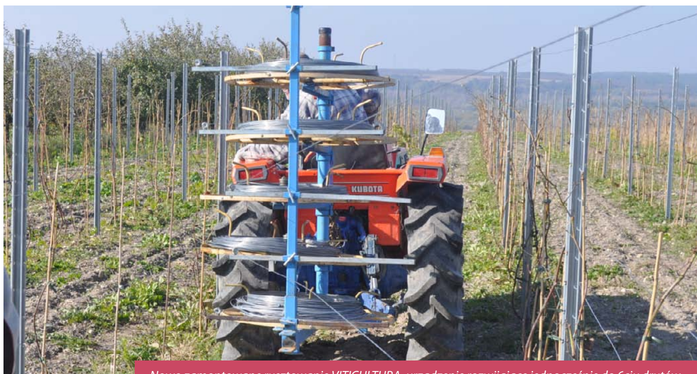
Nowo zamontowane rusztowanie VITICULTURA, urządzenie rozwijające jednocześnie do 6ciu drutów, Winnica Dom Bliskowice, 2010 r.
